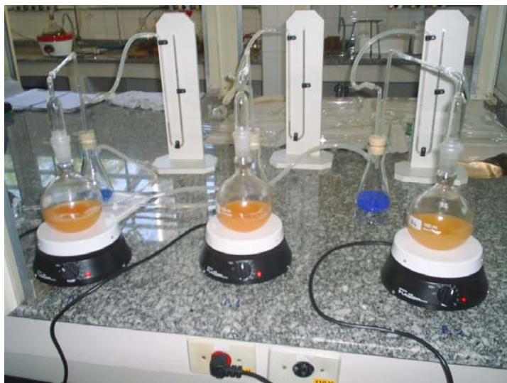
Figura 4. Sistema de captura de voláteis do headspace dinâmico
